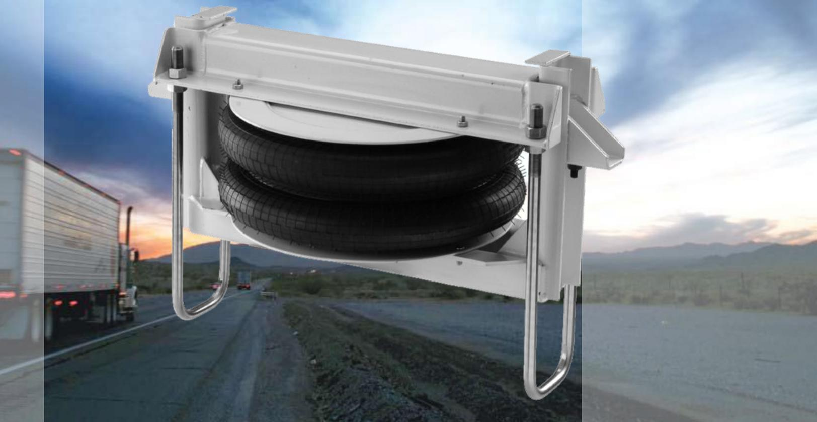
El levante neumático tiene la función de elevación del eje auxiliar del semi-remolque, cuando sin carga. Se trata de un resorte neumático que, una vez inflado, suspende el eje a través de dos grapas fijas en el eje y en la estructura del levante neumático.
